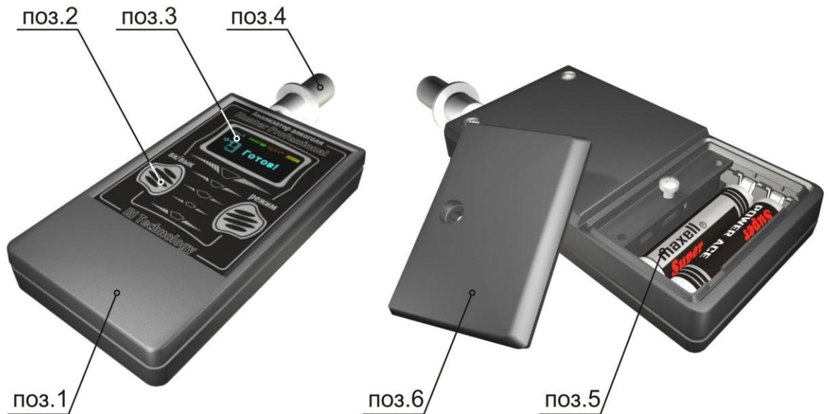
Рисунок 2 – расположение основных частей изделия (на примере предыдущей модели "Hunter Professional")
